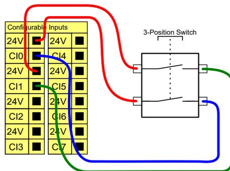
Nota: Los dos canales de entrada para la entrada del dispositivo activador de tres posiciones tienen una tolerancia al desacuerdo de 1 segundo.
