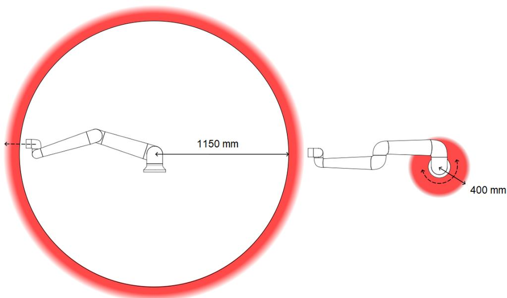
*Debido a las propiedades físicas del brazo robótico, determinadas zonas de espacio de trabajo requieren atención en relación con los peligros de pinzamiento. Se define un área (izquierda) para movimientos radiales cuando la articulación de la muñeca 1 está al menos a 1150 mm de la base del robot. La otra área (derecha) está a 400 mm de la base del robot al moverse tangencialmente.*
