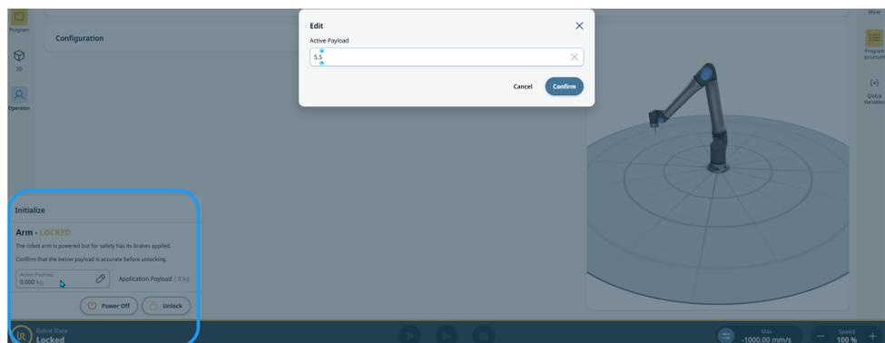
13. Pulse **Desbloquear** para que el brazo robótico libere su sistema de frenos.
