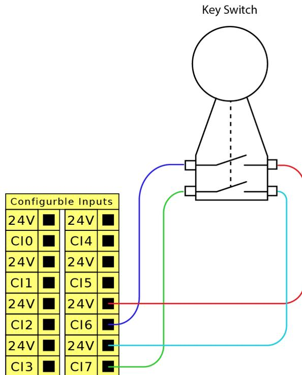
**Para configurar las entradas de seguridad conectadas**
