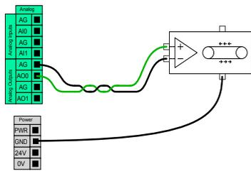
Este ejemplo ilustra cómo controlar un transportador con una salida analógica de control de velocidad.
