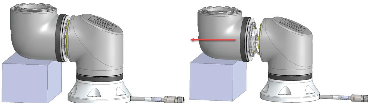
6. Desenchufe suavemente el conector del PCB en la articulación.
