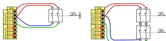
**Uso compartido de la parada de emergencia con otras máquinas**
