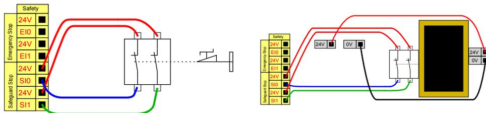
Este ejemplo ilustra un interruptor de puerta como un dispositivo de protección básico donde el robot se detiene cuando la puerta se abre.
